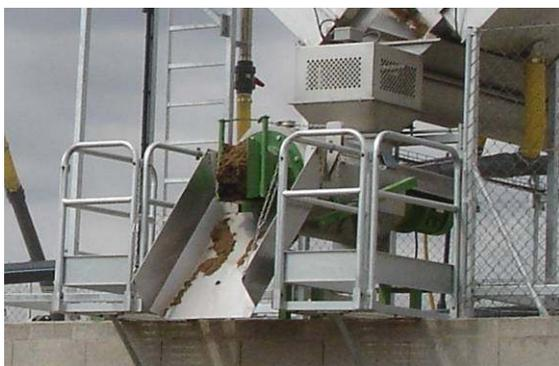
Separador prensa MS-300 de acero inoxidable fabricado por Mecàniques Segalés, accionado por un motor de 5,5 kW, de rosca reforzada con tungsteno, un tamiz de malla triangular de 0,5 mm de paso y con contrapeso de presión a las compuertas de la fracción sólida.
