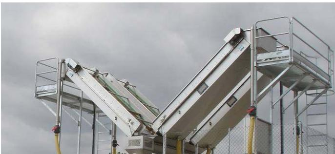
Equipo fabricado por Mecàniques Segalés, compuesto por 4 rampas de filtrado con tamiz de acero inoxidable de 0,65 mm de paso, cepillos de limpieza accionados por motores de 0,25 kW y un transportador sinfín que empuja el sólido hasta el separador.
